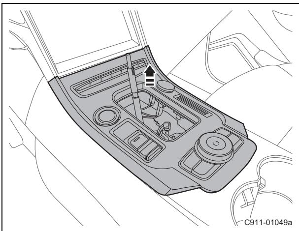
(c). 拆卸副仪表板换档面板总成。
