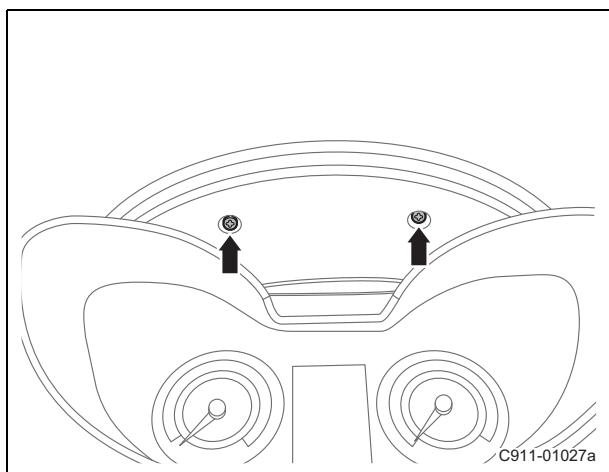
(g). 拆卸组合仪表护罩固定螺钉, 取下组合仪表护罩。
