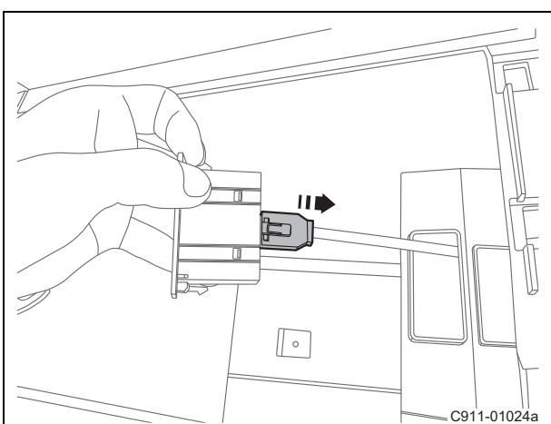
(s). 取下 USB，断开 USB 线束连接器。
