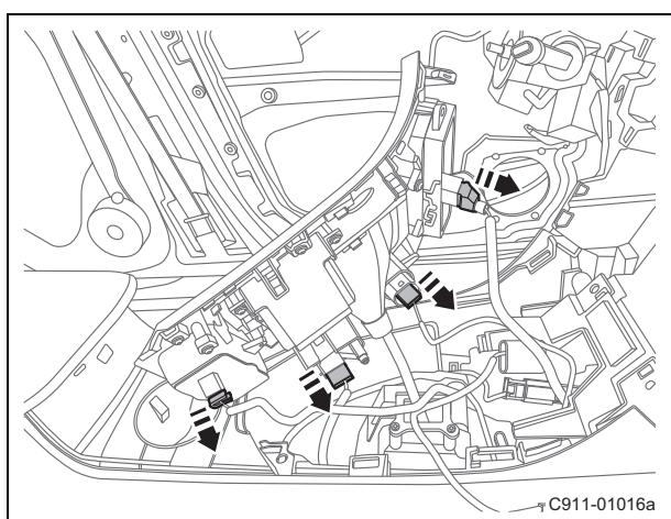
(d). 断开副仪表板换挡面板总成线束连接器。
