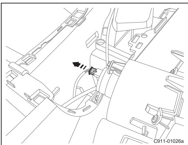
(r). 断开防盗线圈线束连接器。
