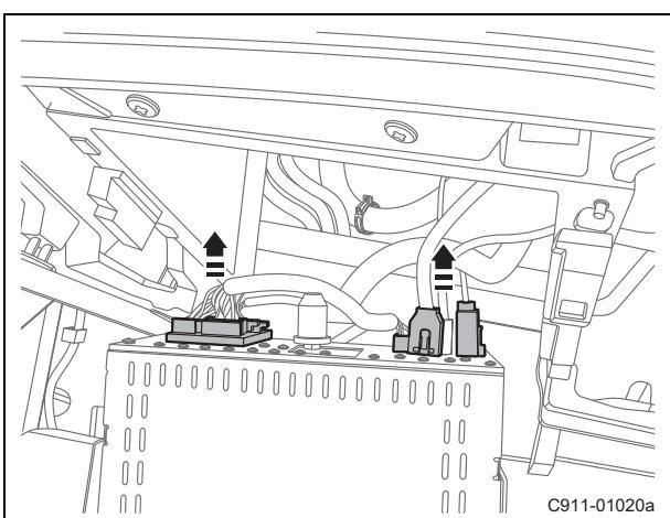
(m). 断开多媒体收音机总成线束连接器。
