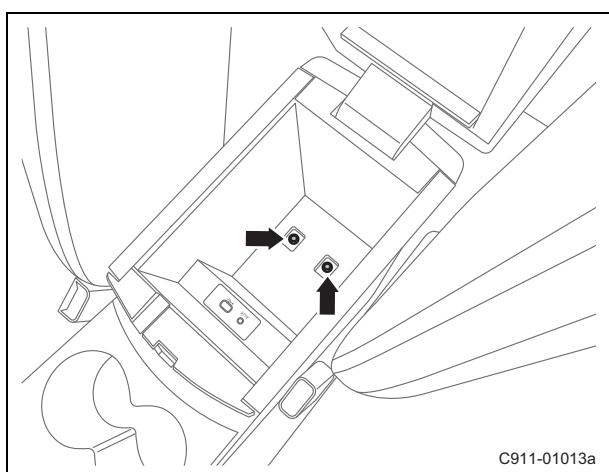
(d). 打开副仪表板扶手储物盒盖, 拆卸储物盒内固定螺栓。
