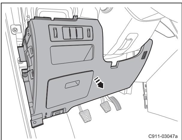
(f). 使用合适的工具拆卸仪表板左下护板总成。
