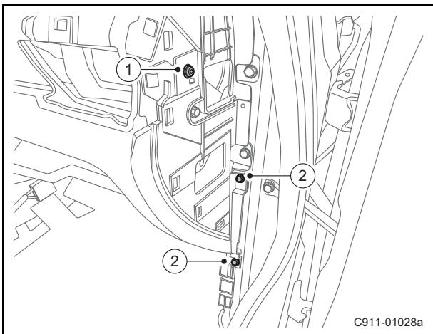
(l). 拆卸仪表台下本体总成右侧固定螺钉 1。
