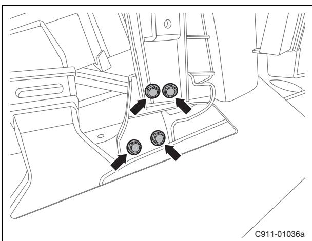
(k). 拆卸仪表骨架下部右侧连接固定螺栓，取
