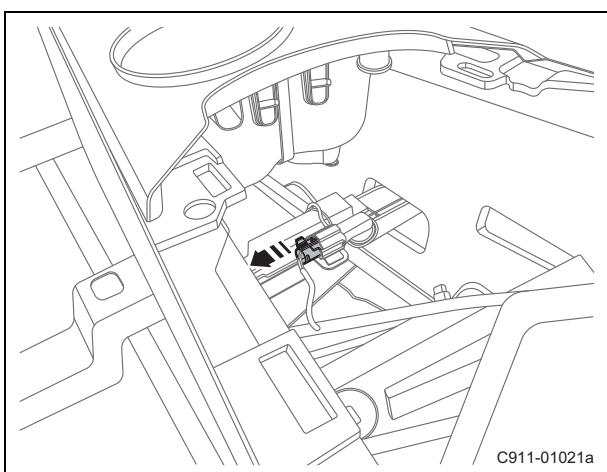
(o). 断开车内天线总成线束连接器。
