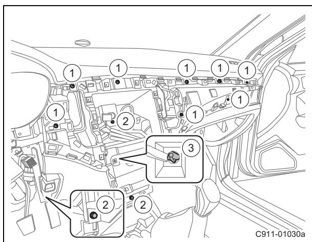
(h). 拆卸仪表台下本体总成固定螺钉 1。
