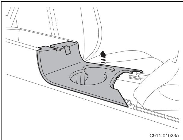
(q). 拆卸杯托。
