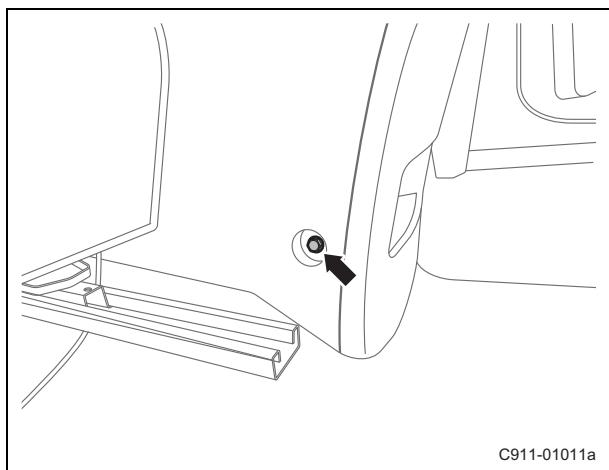
(b). 移动驾驶员座椅至最前位置, 拆卸副仪表板扶手左侧固定螺栓。
